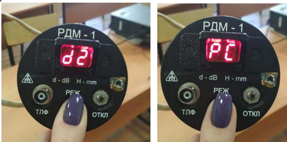
Рис.112. Вид передней панели электронного блока дефектоскопа с включенными режимами.
