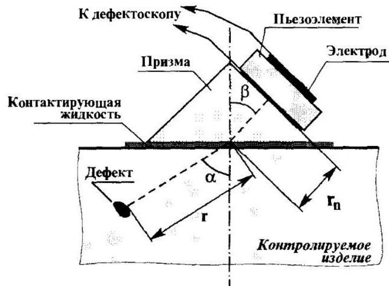
Рис. 36. Путь ультразвуковых колебаний при наклонном вводе.
