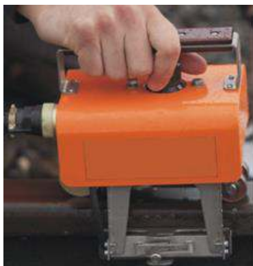
Рис.120. Сканер для контроля с получением 3D-изображения.
