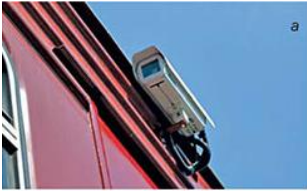
Рис.170. Линейная (а) и обзорная (б) камеры видеосистемы.
