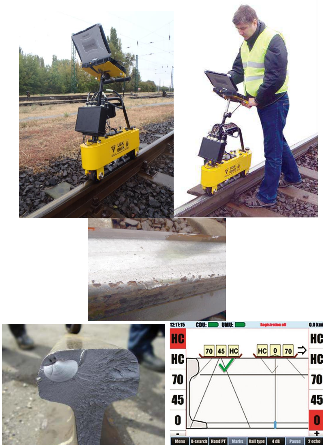
Рис.106. Общий вид и схема прозвучивания дефектоскопа USK-004R.
