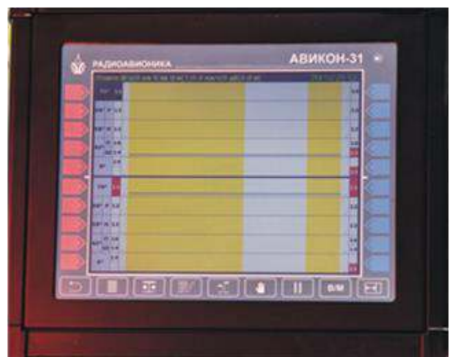
Рис.117. Общий вид и панель блока управления дефектоскопа АВИКОН-31.
