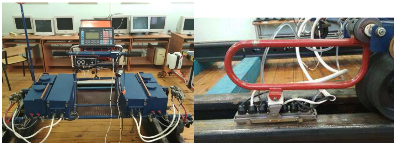
Рис.114. Общий вид и скользящей искательной системы дефектоскопа АВИКОН-01.
