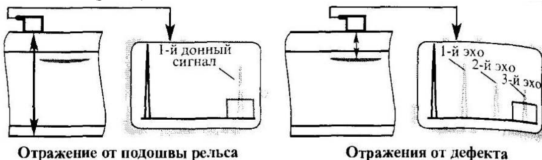
Рис.87. Пропуск дефекта из-за попадания многократно (3-хкратно) переотраженного от дефекта и поверхности катания эхо-сигнала в зону апробироваия донного сигнала.
